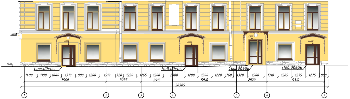
Фасад (фрагмент) в осях А/1-7 М 1:100
